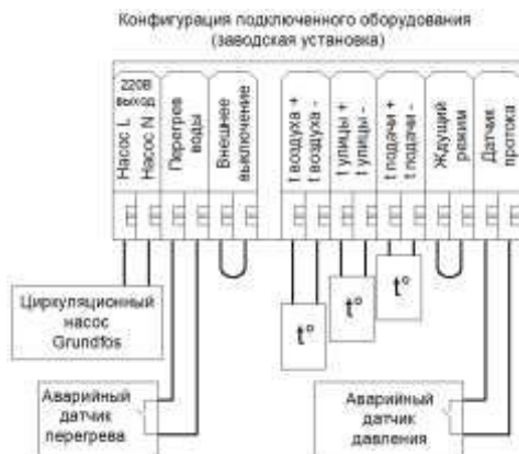
Рисунок 6. Колодка подключения внешнего оборудования
